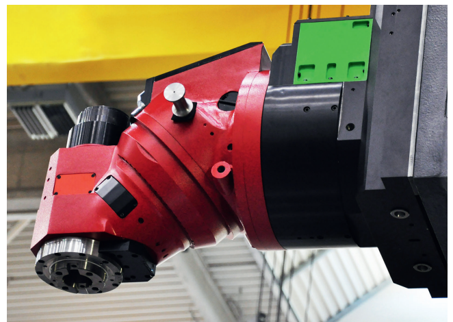
2 Die FGC ist mit einem Universal-CNC-Fräskopf ›UHAmi SDHS‹ ausgestattet. Die technischen Features: automatisches Einwechseln und Positionieren (0,001°), stufenlos schwenkbar, hydraulische Werkzeugspannung, Werkzeugaufnahme HSK 100, Höchstdrehzahl 4000 min -1 , Antriebsleistung 46 kW, Drehmoment 1500 Nm
