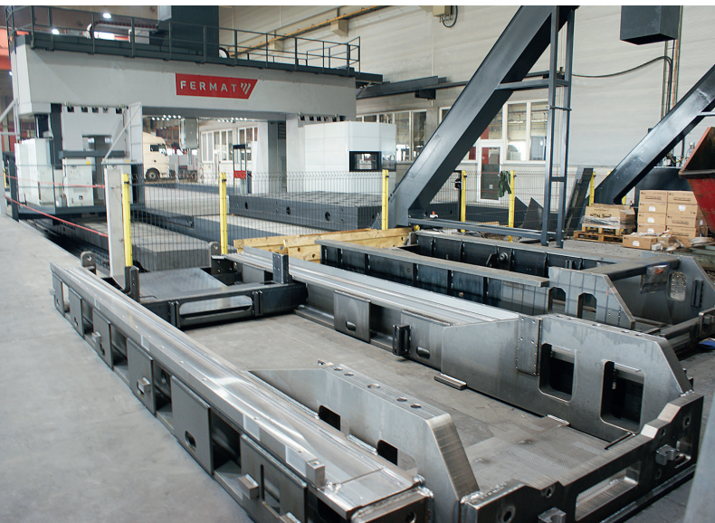
4 An der Rückseite der mächtigen FGC-Portalmaschine warten Großteile auf ihre Bearbeitung © FERMAT
