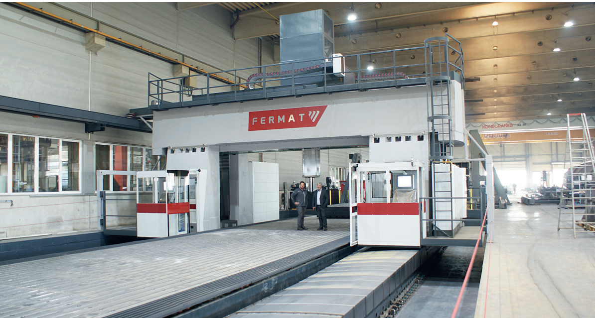
1 Die Portalmaschine FGC von FERMAT mit Verfahrwegen von 20 000 mm in der X- und 7800 mm in der Y-Achse füllt bei ISW eine halbe Halle; die Maschine ist mit zwei verfahrbaren Bedienerkabinen und zwei Späneförderern ausgestattet; als Steuerung dient eine TNC 640 von Heidenhain © FERMAT
